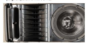
Figura 1. Vista ravvicinata della guida d'onda QSC LEAF™ nel diffusore line array attivo LA108.
