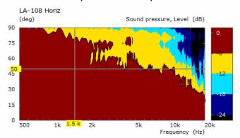
Figura 4. Curve di copertura simulate e misurate della guida d'onda del diffusore LA 108 a una distanza di 4 m (13 piedi).
