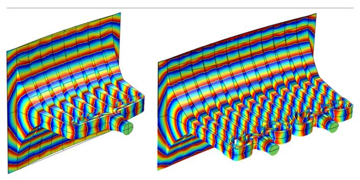
Figura 3. Viste isometriche che illustrano l'analisi di fase all'interno delle guide d'onda LA108 (sinistra) e LA112 (destra) a 15 kHz.
