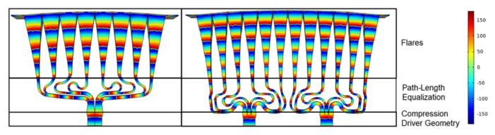
Figura 2. Analisi di fase all'interno delle guide d'onda LA 108 (sinistra) e LA 112 (destra) a 15 kHz in una sezione trasversale all'interno del piano di accoppiamento.
