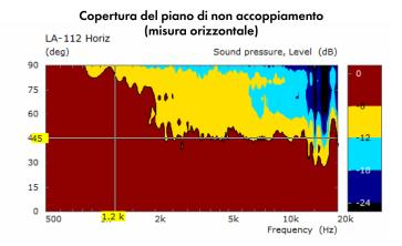
Figura 5. Curve di copertura simulate e misurate della guida d'onda del diffusore LA 112 a una distanza di 4 m (13 piedi).
