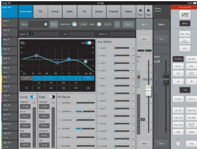
**Übersichtsdarstellung** eines Eingangs in der iPad App. Dank des geschickten Aufbaus der Oberfläche ist man mit einem Fingertipp an fast an allen wichtigen Positionen. (Abb. 3)
