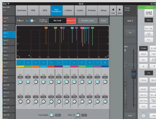
**Anti-Feedback-Assistent** zur automatisierten Suche von Feedback kritischen Frequenzen und der entsprechenden Filterung dazu (Abb. 19)
