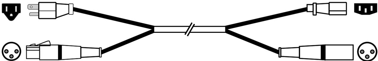
A través de terceros proveedores, hay disponible diferentes combinaciones de cables en tamaños a medida. Combinan alimentación AC (EIC o powerCON) con un canal XLR a XLR en un cable forrado. El zumbido de los cables de alimentación no se transmite a la línea de audio gracias al par conductor firmemente trenzado del cable de audio y al rendimiento CMR (rechazo al modo común) del circuito balanceado de las entradas de los amplificadores de la serie K.
