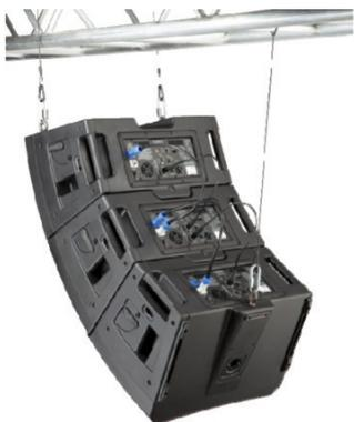
KLA ofrece soluciones tanto para suspensiones temporales como permanentes. Para instalaciones permanentes, cada elemento tiene cuatro puntos roscados M10 en la parte superior de la caja y uno en la parte inferior central de la parte trasera para ajustar su ángulo.
