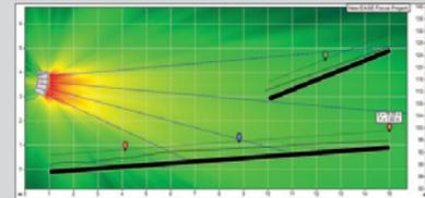
Utilice EASE Focus para predecir la cobertura vertical de cada array KLA. Descargue EASE Focus gratis en: <https://www.qsc.com/resources/software-and-firmware/loudspeakers/>
