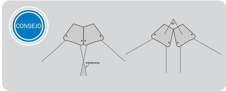
Imagen 3: Cuando coloque en array dos cajas KW152 de 60°, no obstruya la superficie lateral de 18° (izquierda), ya que produciría una dispersión de tan solo 36° y la superposición de energía generaría un fuerte filtro de peine en la zona de escucha. En su lugar, utilice una dispersión de 60° entre las cajas (derecha) para minimizar la superposición y aumentar a 120° el ángulo de cobertura total.
