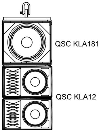
Una posible desventaja de los subwoofers suspendidos es la falta de superficie (suelo o pared) donde se produzca acoplamiento acústico con el suelo, aunque el techo pueda funcionar como barrera en algunos casos.
