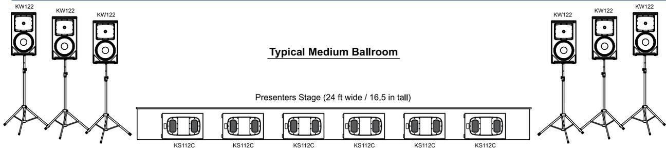
Como se muestra en la anterior sugerencia de aplicación, una relación típica entre caja de altavoz y subwoofer con los productos de la Serie K utilizados en interiores es de 1:1. En aplicaciones al aire libre donde no haya muros ni techo que contengan la energía de las frecuencias graves, doble la relación del subwoofer a 1:2..
