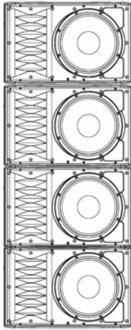
Imagen 1. Array vertical de cuatro KLA12
